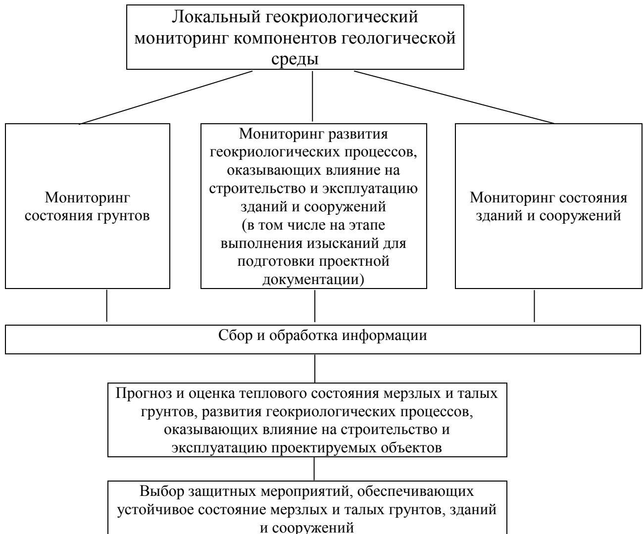
Рисунок Ж.3.1 – Структурная схема локального геокриологического мониторинга компонентов геологической среды
