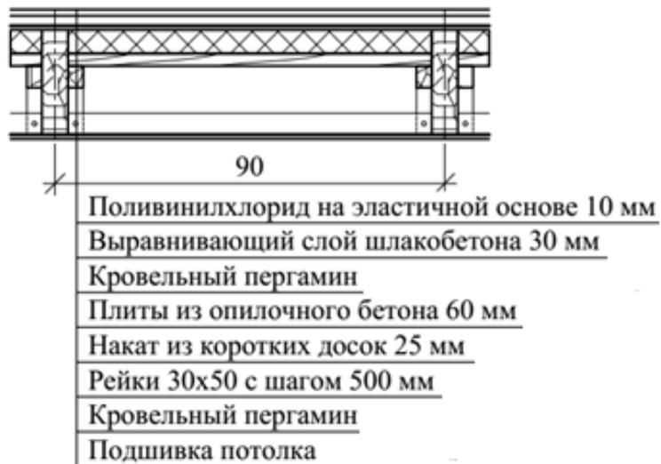
а – по доскам, установленным на ребро;
