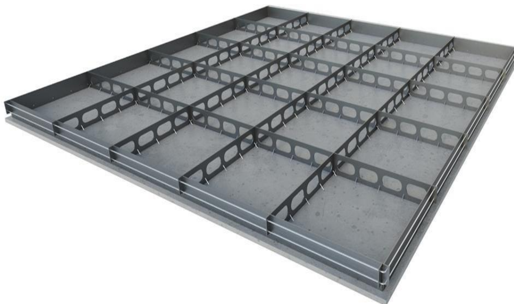
Рисунок 7.12 – Общий вид верхней плиты с металлическим каркасом
