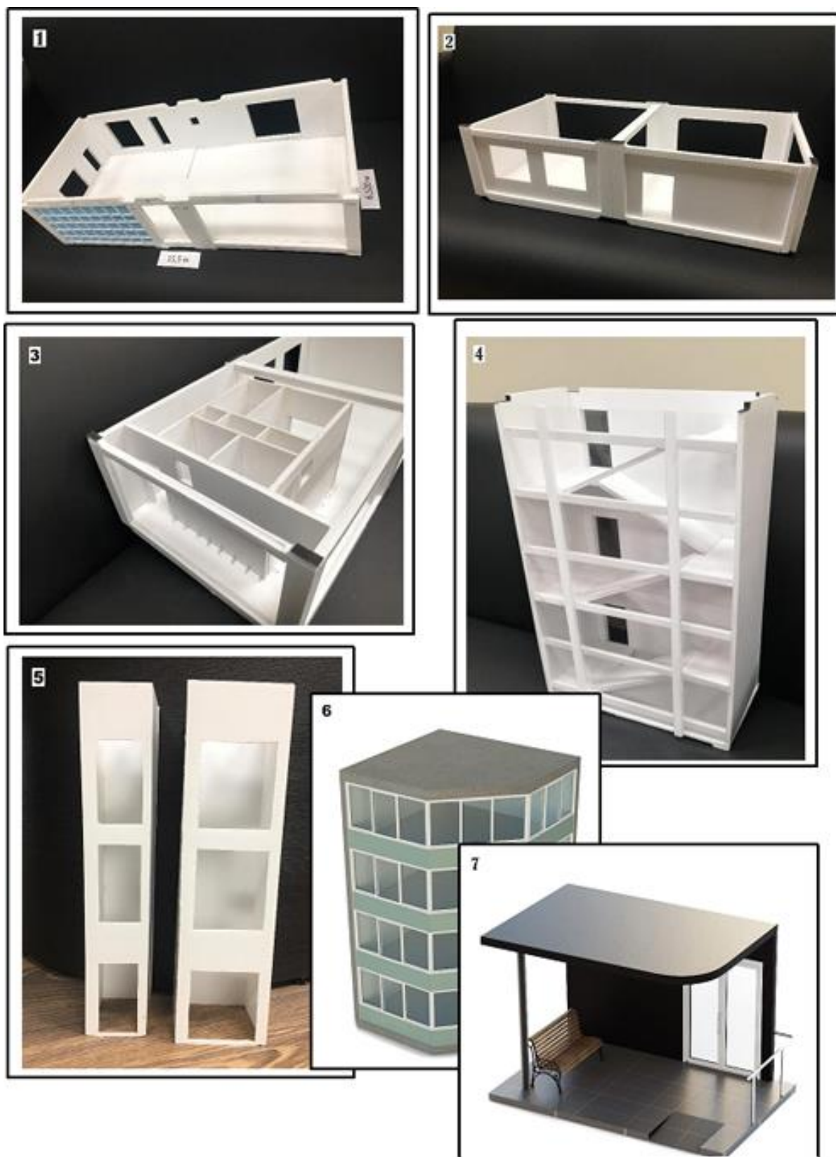
1 – основной КГМ; 2 – КГМ с меньшим числом пилонов; 3 – КГМ МОП ЛФУ; 4 – модуль ЭВЛ; 5 – блок-модуль ШЛ; 6 – блок многоэтажной системы балконов, эркеров и т. п.; 7 – вход
